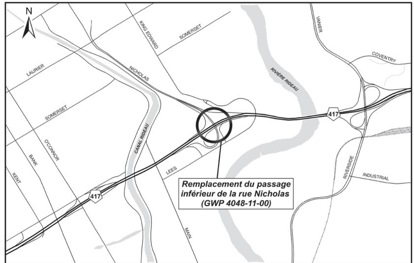
Le remplacement du passage inférieur exigera, à deux reprises, la fermeture complète de l'autoroute 417 pour l'érection des poutres du nouveau pont au-dessus de l'autoroute et pour la démolition de la structure actuelle. Chaque fermeture aura lieu durant une fin de semaine distincte. La circulation sera détournée à cette occasion et, pendant les étapes de construction, sera gérée en coordination avec la ville d'Ottawa.
